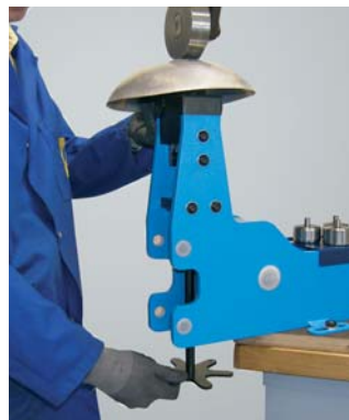
Spindelrad zur Regulierung des Arbeitsdruckes.
