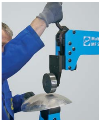
Schnellspanmechanismus zum Spannen der Bauteile.
