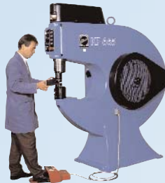
Grösste Eckold Umform-Maschine KF 665 mit 675 mm horizontaler Ausladung
