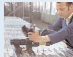
Partielles Stauchen vom Tragflügel für DORNIER Do 228
