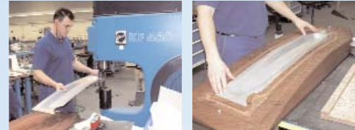
Richten eines Abdeckungsteiles im Bodenbereich für den neuen Airbus A380 mit dem Kraftformer KF460
