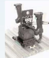
Richten von einem Tragflügelspannblech mit speziellen RIG-016 Werkzeug
